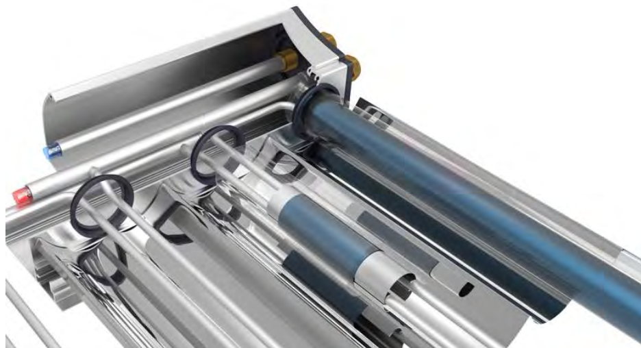
Abbildung 5: Teilschnitt eines hinter spiegelt Vakuumröhrenkollektor mit eingeschobenen Röhren, mechanisch gehalten über Dichtring bzw. Plastikkappen am unteren Ende. (Quelle: http://paradigma.de )
