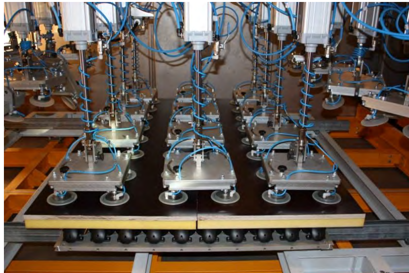
Abbildung 56: Adaptionsvorrichtung zur Prüfung von VRK (zwei Module)
