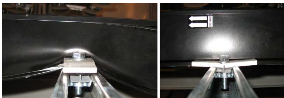
Abbildung 49: Versagen im Bereich der Kollektorbefestigungen mit geringerer Auflagefläche (links), kein Versagen des gegenüberliegenden Rahmenprofils mit alternativen Kollektorbefestigungen (rechts)
