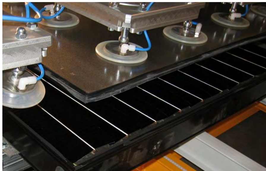
Abbildung 46: Scheibe nach erstem Zykluswechsel aus schwimmender Lagerung gerissen bei Anwendung der PV-Prüfnorm
