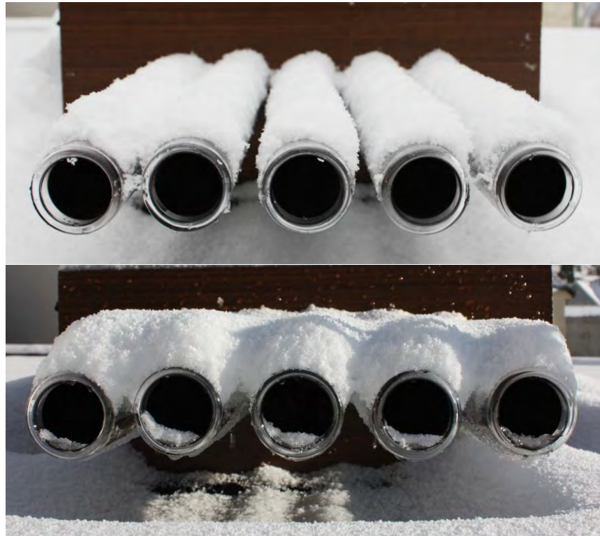
Abbildung 44: Schneeanlagerung VRK nach einem (oben) und drei Tagen (unten) ab 20. Januar 2012 (Quelle: [Göring 2012])
