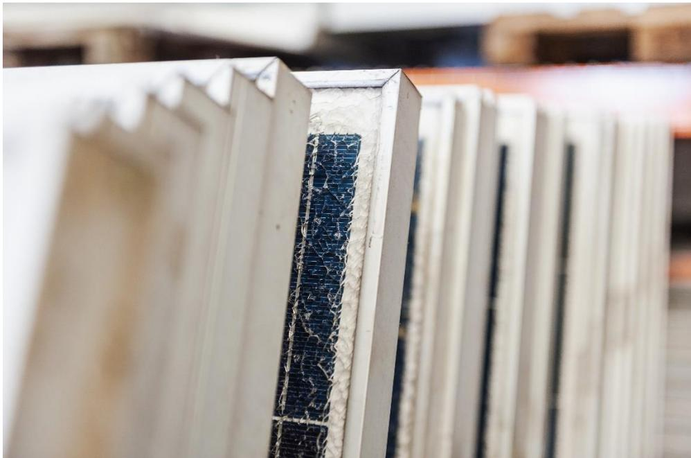
Detailaufnahme ausgedienter PV-Module. Das Start-Up Solar Materials widmet sich dem Recycling von PV-Modulen. © Solar Materials GmbH
