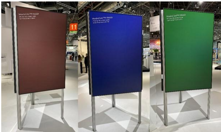
Abb. 2 Demonstrator-Module mit MorphoColor®-Farbschicht, wie sie in grün und blau auf der BAU 2023 zu sehen sein werden. Bei den drei realisierten Farben wurden ein PV-Wirkungsgrad von 94-96 Prozent im Vergleich zum schwarzen Referenzmodul ohne Farbschicht gemessen. © Fraunhofer ISE / Foto: Thomas Kroyer
