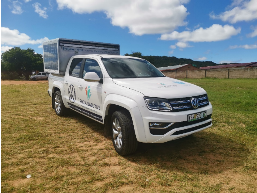
Der erste Prototyp der Versorgungseinheit, die auf einen Volkswagen Amarok montiert wurde. © Fraunhofer IST, Frank Neumann
