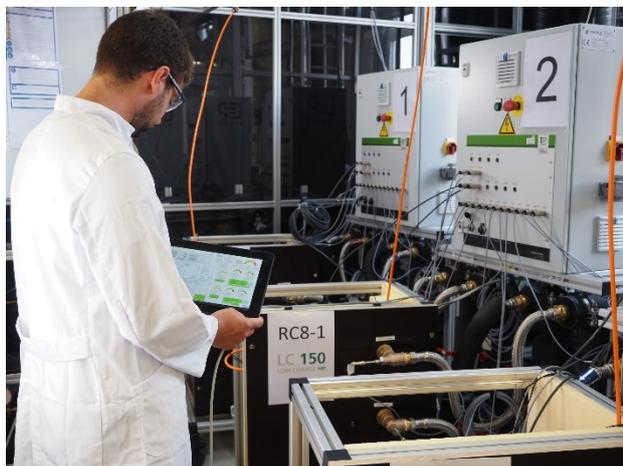
Auf der Suche nach der besten Wärmepumpe werden im Projekt LC 150 Dutzende Kombinationen von Komponenten getestet. © Fraunhofer ISE
