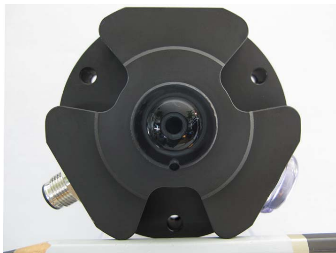
Sonnenstandsmessgerät zur Messung der Nachführgenauigkeit von Trackern. ©Black Photon Instruments
