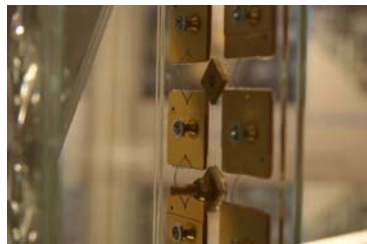
Noch mehr Konzentration: Mit Sekundäroptik arbeitet das Fraunhofer ISE an der Effizienzsteigerung von Photovoltaik-Konzentratormodulen. © Fraunhofer ISE
