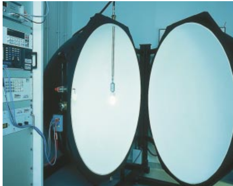
Abb. 1: Kugel-Photometer zur Lichtstrommessung an DC-Lampen und -Leuchten.
