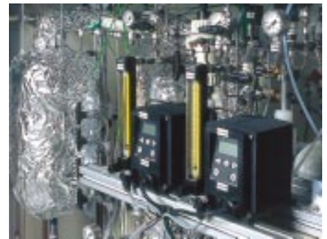
Abb. 1: Teststand für den POA-Kerosinreformer. Im Bildausschnitt: Eduktdosierung und Reaktor.
