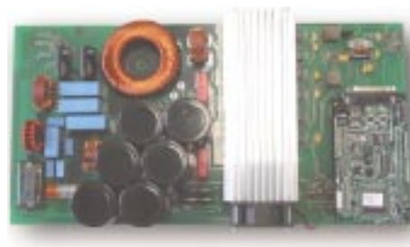
Abb. 1: Am Fraunhofer ISE entwickelte Plattform für Wechselrichter der nächsten Generation. Sie verwendet die HERIC®-Topologie.
