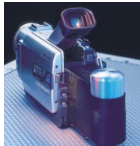
Abb. 3: Komplett integriertes Brennstoffzellen-System für einen handelsüblichen DV-Camcorder. Demonstrations-System der Fraunhofer-Initiative Mikrobrennstoffzelle unter Leitung des Fraunhofer ISE.
