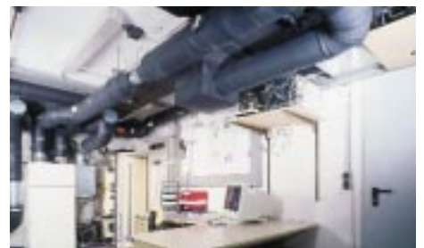
Abb. 3: Automatisierter Teststand mit zwei Testplätzen zur Messung von Lüftungsgeräten mit Abluftwärmepumpe.
