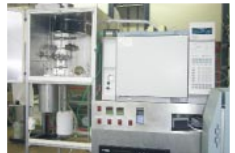
Abb. 4: Teststand zur Charakterisierung von Katalysatoren zur Gasprozesstechnik. Mit dem rechts im Bild sichtbaren Gaschromatographen können wir die Zusammensetzung von Produkt- und Eduktgasen messen.
