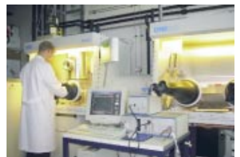
Abb. 3: Herstellung der Organischen Solarzellen in der Glovebox.
