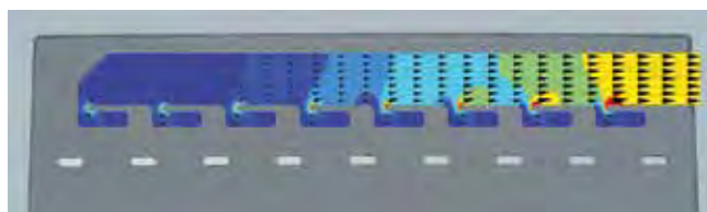
2 FEM-Simulation des Stromtransports in einem strukturierten Zellverbinder: ohmsche Verluste (Farbe), Stromrichtungen (Pfeile).
