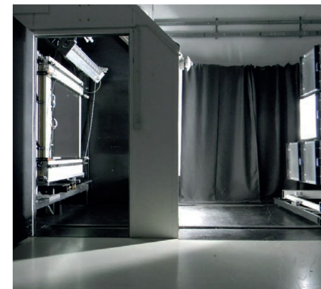
Kalorimeterteststand des TestLab Solar Façades mit Solarsimulator zur Messung des Gesamtenergiedurchlassgrades (g-Wert).
