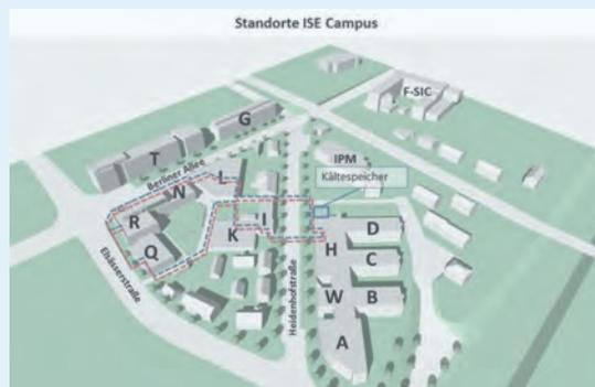
Verlauf der Wärme- (rot) und Kälteleitungen (blau), sowie mögliche Standorte für die zu errichtenden Speicher auf dem Campus des Fraunhofer ISE.
